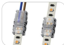
5.8、安装结束(切勿在同一灯带位置上反复安装刺穿焊盘，如果端子安装失败，请将已刺破的改单元组灯带剪掉舍弃，于新焊盘处安装端子)
