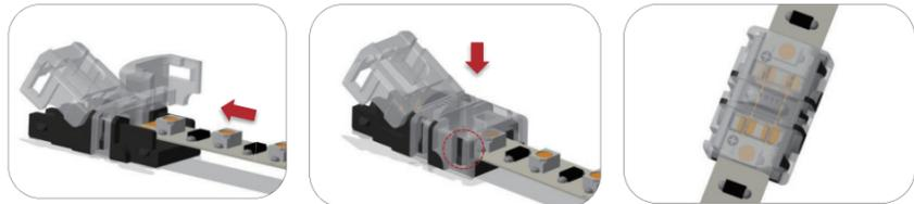
5.4、放入灯带，注意灯带在五金接触针上部，灯珠面朝翻盖向，关闭透明翻盖完全与底座两侧锁住，可借助工具（电子钳子）。
